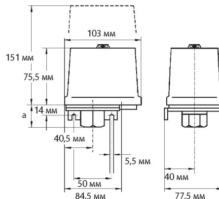
Разъем для подвода давления, датчик давления (чувствительный элемент), переключающий механизм и контакты для электрического подключения аппарата – все это смонтировано на шасси аппарата, выполненного из легкого сплава литьем под давлением. Прозрачная крышка из поликарбоната защищает переключатель и шкалу от воздействия факторов окружающей среды.
